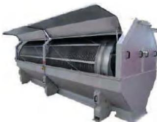
**DEGRAISSEUR DESSABLEUR** : équipement dont la fonction est la séparation physique, par différence de gravité, des graisses et des huiles d'origine végétale et animale ainsi que la décantation des solides de taille supérieure.
